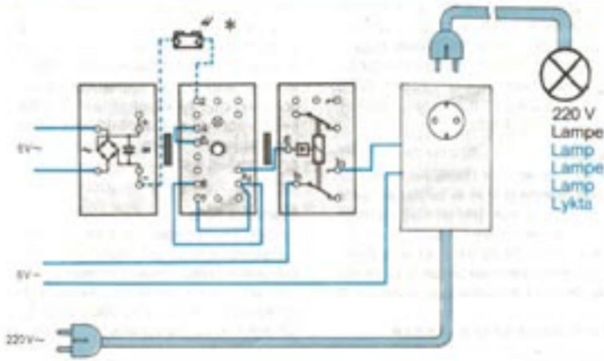
Taktgesteuerte Schaufensterbeleuchtung mit \* Sperrung bei Tage, gebaut mit ec 2 oder hobby 4
