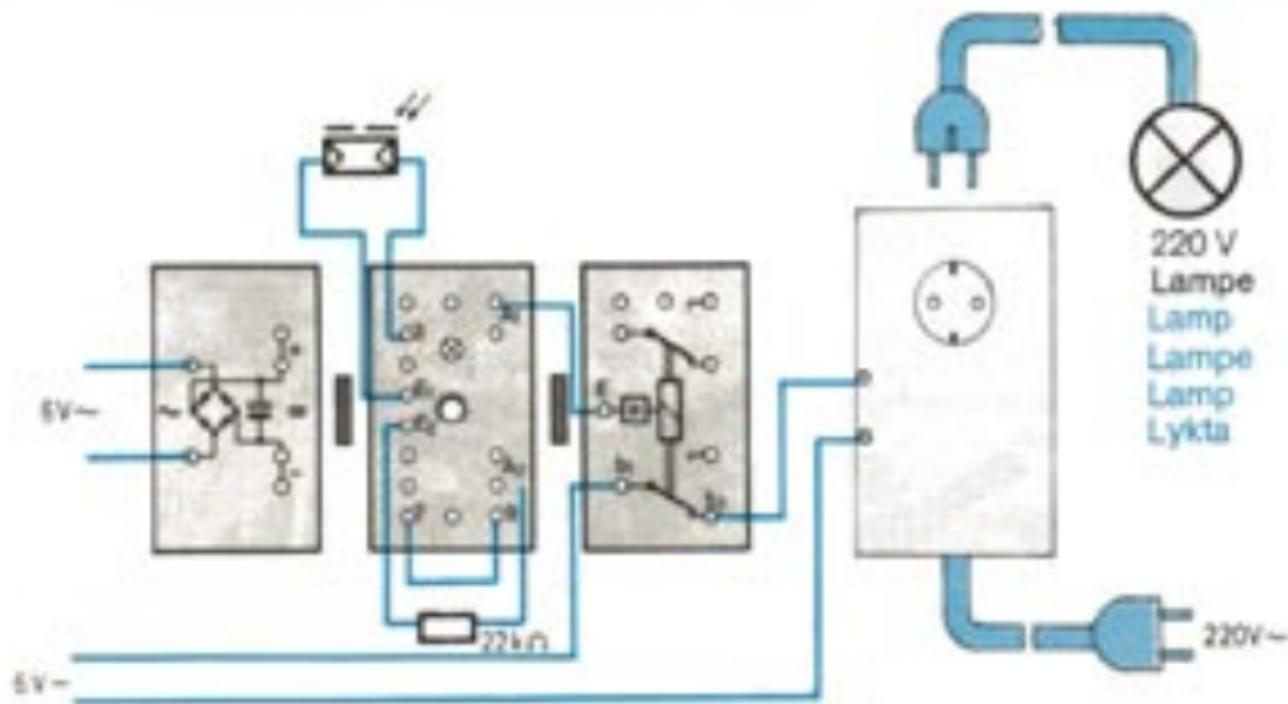
Dämmerungsschalter, gebaut mit fischertechnik ec 2 oder hobby 4 und Netzschaftgerät
